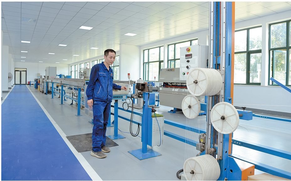
华菱线缆高温挤塑生产线。(本报记者 方阳摄)
