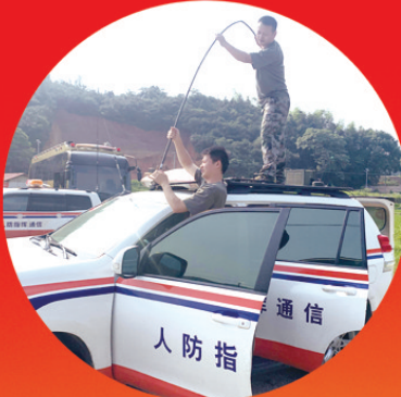
信息采集车短波电台天线 架设
