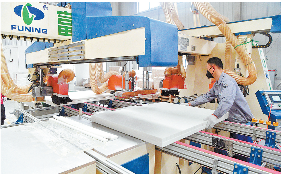
湖南伊索尔复合材料有限公司生产车间内，工人们正在生产加工叶片夹芯材料。
