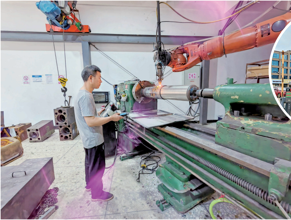
← 再制造成为中部国际机械物流园新兴起的产业板块。图为采用激光对一轴承进行再制造处理。 (本报记者 马贵 摄)
