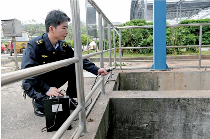
马超在河东污水处理厂用FID便携式氢火焰离子化检测仪对有机废气进行现场检测。(本报记者 陈旭东 摄)
