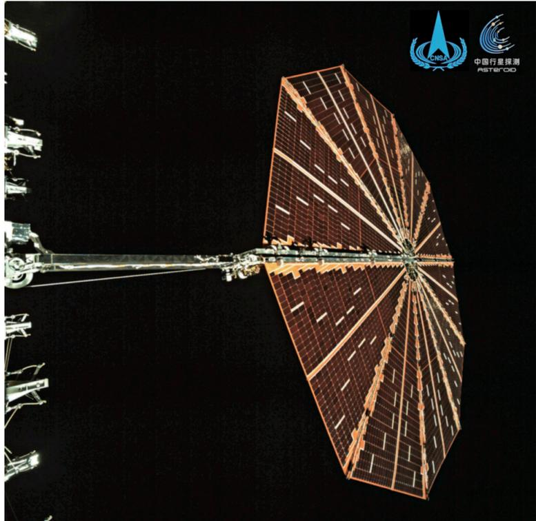
6月6日，国家航天局发布天问二号探测器传回的圆形柔性太阳翼展开的图片。为满足在距离太阳约3.75亿千米的主带彗星开展探测的供电需求，天问二号探测器研发配置了圆形柔性太阳翼。
